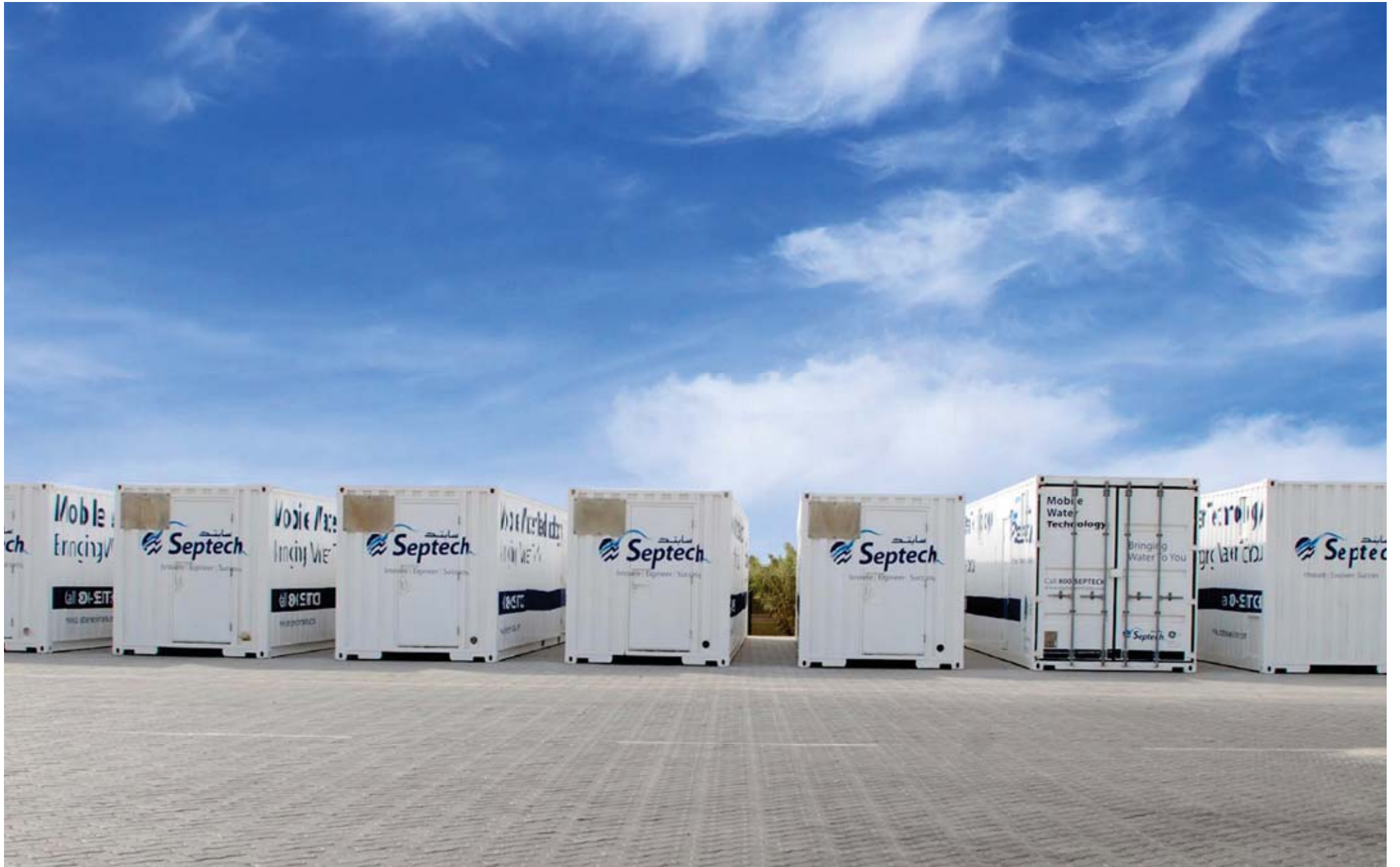
集装箱装的海水反向渗透每天1000立方米/海水淡化的移动单位
