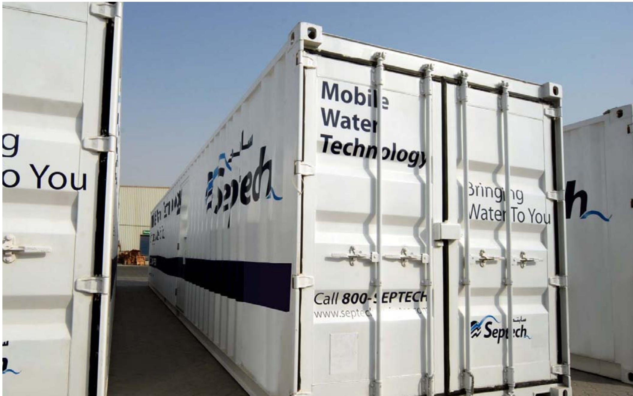
集装箱装的海水反向渗透每天1000立方米/海水淡化的移动单位
